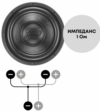
Сабвуферы параллельно, катушки параллельно
