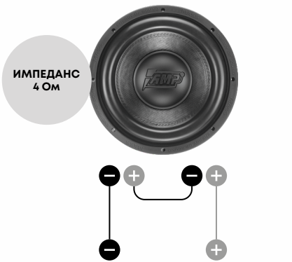
Сабвуферы параллельно, катушки последовательно
